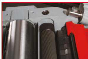
spiralverzahnte Einzugswalze spiral-toothed infeed roller
