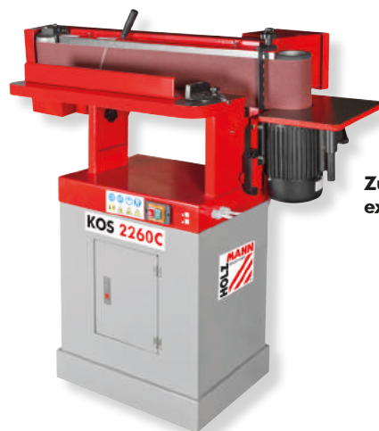
Haube für verbesserte Staubabsaugung hood for improved dust collection
