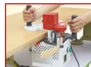
gerade Kanten straight edge bending
